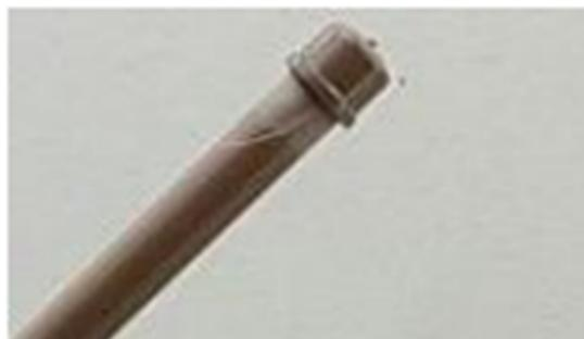
Passe a fita isolante em torno da bobina, inclusive nos furos. Obs: Não bloqueie nem feche a extremidade inferior do tubo. Isto é para permitir a drenagem da condensação.
