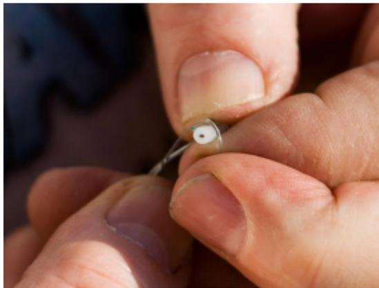
**Passo 4:** comprimento do cabo interno ao tubo o Meça 44,7cm no ponto onde a malha e a capa do cabo (preta) começa). Esta é a distância até o início (ou parte superior) da bobina e marque esta posição no coaxial com um pedaço de fita, de modo a ser um ponto de referência de parada ao inserir o cabo dentro do tubo.
