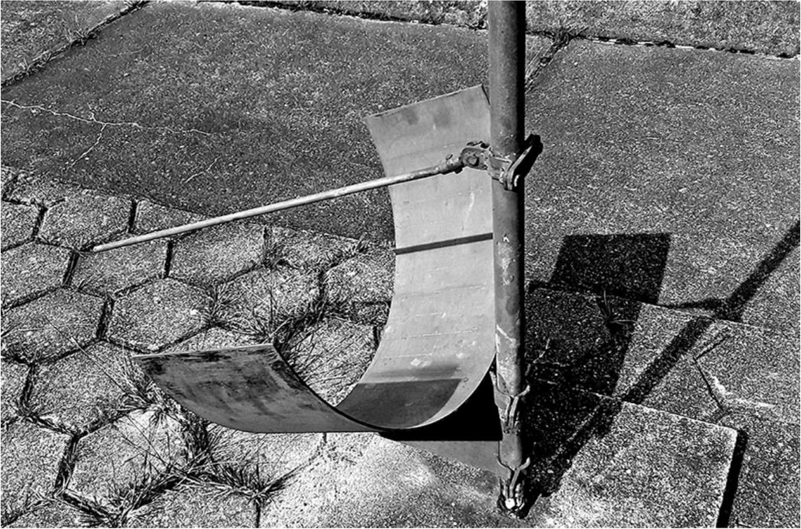
FIGURA 12: Relógio de Sol polar cilíndrico.
