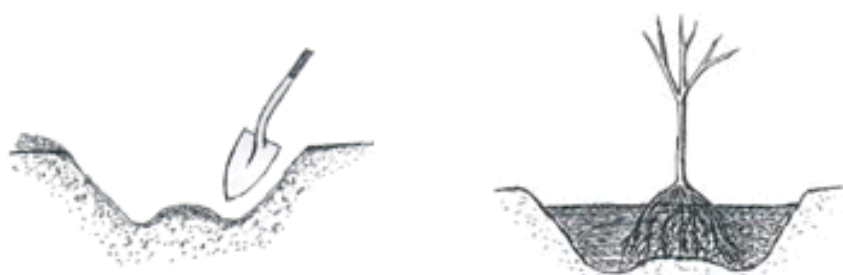
FIGURA 9 – Maneira correta de cavar um buraco e de colocar a muda
